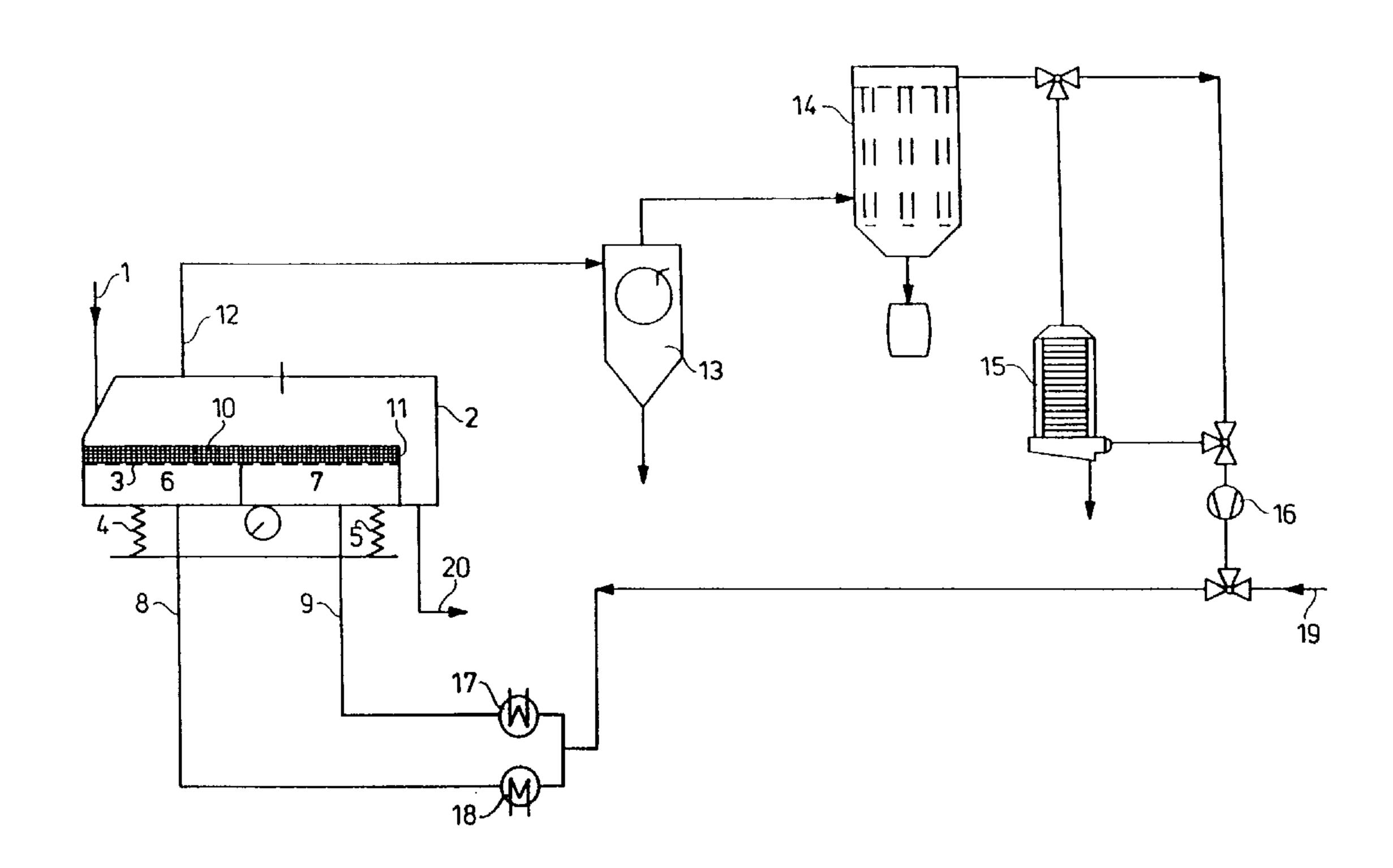
(57) L'invention concerne un procédé pour dégazer des particules de caoutchouc obtenues par polymérisation en phase gazeuse. Selon ce procédé, les particules de caoutchouc sont maintenues constamment en mouvement dans un lit fluidisé à vibrations tout en étant traversées par un flux de gaz.
