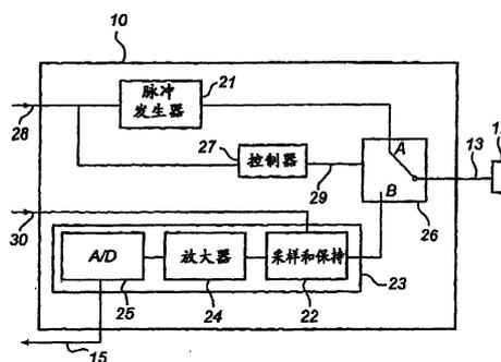
1. 一种雷达液位仪，打算用于使用近距离低功率雷达来测量容器中的内容的表面相对于测量位置的距离，所述测量位置位于表面之上，并且相对于所述容器的较低边界被几何限定，所述雷达液位仪包括：
