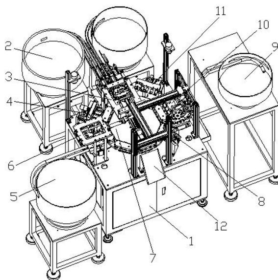
1. 一种消毒注胶后的三通细软管装帽机,包括主体机架(1)和设置在主体机架(1)内的配电控制箱,所述的主体机架(1)上方中部设置有转盘装置(7),其特征在于,所述的转盘装置(7)包括固定在主体机架(1)上相互配合的转盘电机(15)和转盘(13),所述的转盘(13)上方沿圆环均匀设置有载具组件(16),下方设置有固定在主体机架(1)底板上的转盘限位器(14),所述的载具组件(16)包括固定在转盘(13)上的载具下板(79),所述的载具下板(79)上方对应设置有载具上板(78),侧边固定安装有推料导向板(77),所述的载具上板(78)下端与载具下板(79)上端面开设有跟三通细软管(82)配合的半圆形通孔,所述的载具组件(16)下方设置有产品压盖松弛开关(17),所述的产品压盖松弛开关(17)的推轴穿过载具下板(79)连接到载具上板(78),所述的主体机架(1)上方沿转盘(13)转动方向依次设置有与各载具组件对接压管装置(8)、胶帽安装装置(10)和拧紧装置(11),所述的转盘电机(15)、压管装置(8)、胶帽安装装置(10)和拧紧装置(11)连接到配电控制箱。
