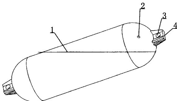
1. 一种充气式 PVC 护舷, 其特征在于: 主体内部中空, 主体呈柱状, 壁厚为 3.5mm, 两端圆滑并设有护舷头, 护舷头处设有环眼, 主体靠一端设有充气孔, 主体采用防紫外线 PVC 材料滚塑成型。
