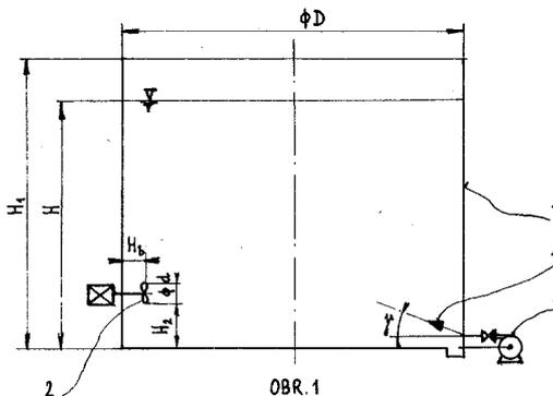
Vynález se týká zásobní a homogenizační nádrže pro kaolinové suspenze, řešící problém homogenizace vodných suspenzí kaolinu při skladování ve velkoobjemových nádržích.
