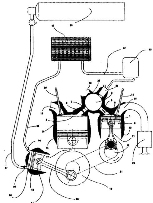
Application à tous moteurs équipés d'injection d'air comprimé. Application à la production d'air climatisé dans le véhicule.
