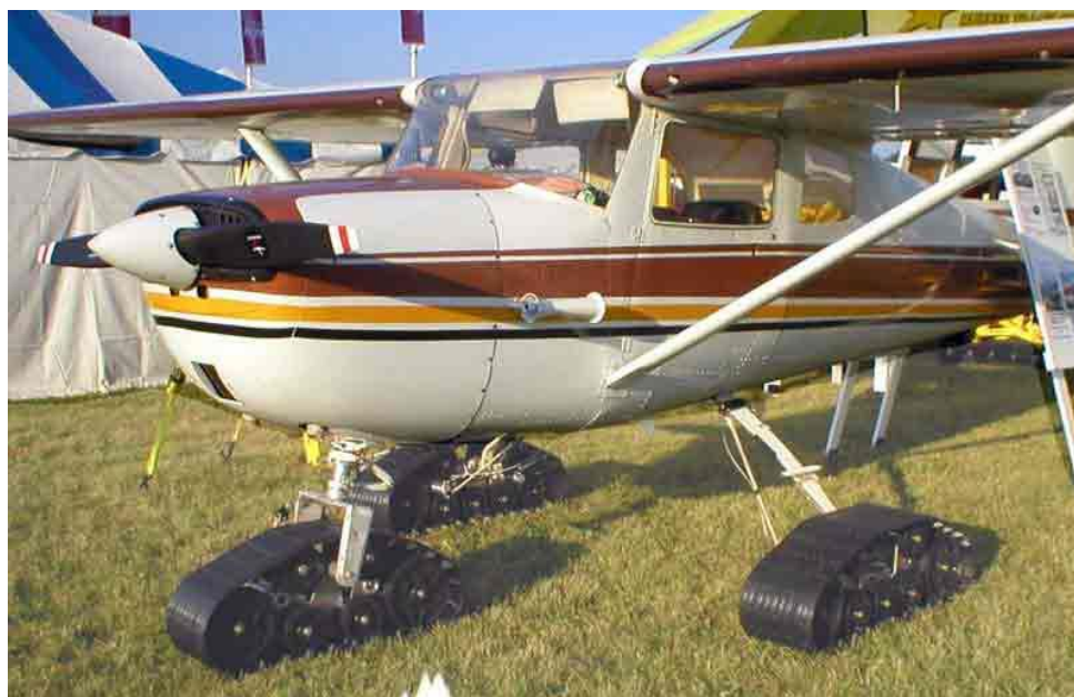
Рисунок 8 – Пример гусеничного шасси
