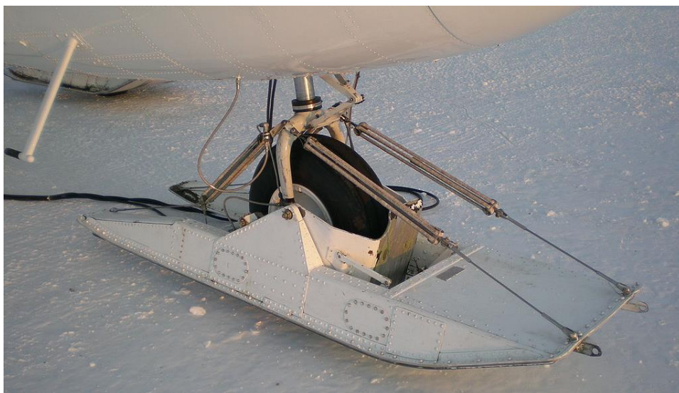
Рисунок 7 – Пример колёсно-лыжного шасси
