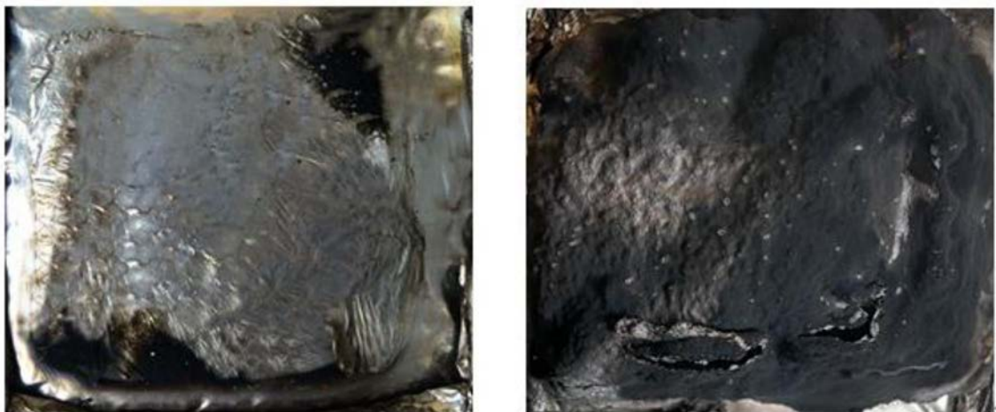
图 4 纯 HDPE (左) 和阻燃 HDPE 复合材料 (右) 锥形量热残余样品的照片
