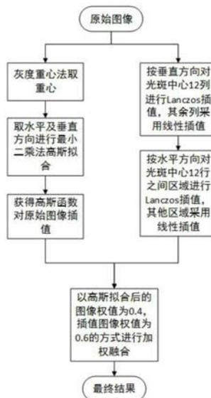
1. 一种用于探测器阵列法测量激光光斑的图像插值方法,其特征在于,包括以下步骤:
