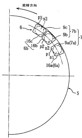
1. 一种盘式制动装置，包括固定到车轮的盘式制动板、在其自身与所述盘式制动板之间产生摩擦力的衬垫单元、使所述衬垫单元与所述盘式制动板进行压力接触的活塞机构、以及保持所述活塞机构的制动钳主体，并且
