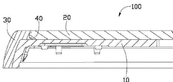
1. 一种电子装置外壳,包括本体及安装于该本体上的视窗,该本体与该视窗的外周缘之间形成接缝,其特征在于:该电子装置外壳还包括连接该本体及该视窗的装饰件,该装饰件由涂料灌注成型形成于该本体与该视窗上且将该接缝覆盖。
