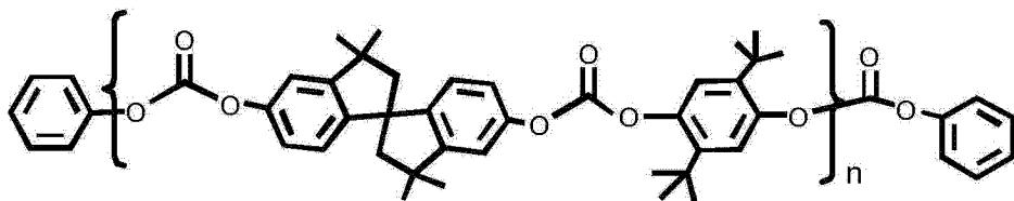
[0084] 预期的是,可以获得具有在 3,000 至 80,000 道尔顿范围内的 Mw、小于 20meq/kg 的酚基含量、小于 20ppm 的含氯量、小于 20ppm 的过渡金属含量、以及小于 100ppm 的剩余单体含量的该举例说明的聚碳酸酯以及本文中公开的其他聚碳酸酯。
