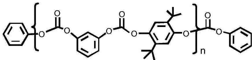
[0078] 预期的是,可以获得具有在 3,000 至 80,000 道尔顿范围内的 Mw、小于 20 毫克当量 / 千克 (meq/kg) 的酚基含量、小于 20ppm 的含氯量、小于 20ppm 的过渡金属含量、以及小于 100ppm 的剩余单体含量的该举例说明的聚碳酸酯以及本文中公开的其他聚碳酸酯。
