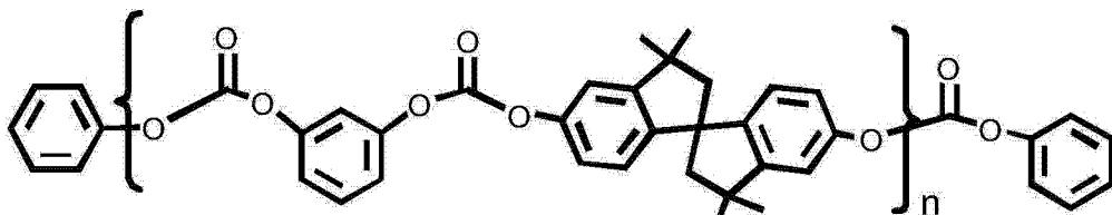
[0081] 预期的是,可以获得具有在 3,000 至 80,000 道尔顿范围内的 Mw、小于 20meq/kg 的酚基含量、小于 20ppm 的含氯量、小于 20ppm 的过渡金属含量、以及小于 100ppm 的剩余单体含量的该举例说明的聚碳酸酯以及本文中公开的其他聚碳酸酯。
