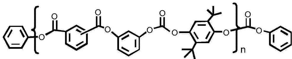
[0087] 预期的是,可以获得具有在3,000至80,000道尔顿范围内的Mw、小于20meq/kg的酚基含量、小于20ppm的含氯量、小于20ppm的过渡金属含量、以及小于100ppm的剩余单体含量的该举例说明的聚碳酸酯以及本文中公开的其他聚碳酸酯。
