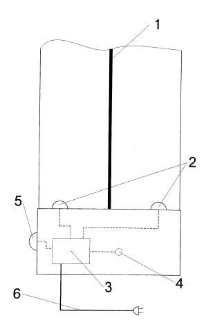
(57) Zusammenfassung: Die Erfindung besteht aus einer blendfreien LED-Leuchte mit programmierbarer Dimmung/ Teilabschaltung, Temperatur- und Alterungskompensation, bei der durch einen mittig angeordneten flachen oder runden Extraktor die Leuchte in getrennt steuerbare Segmente aufgeteilt ist.
