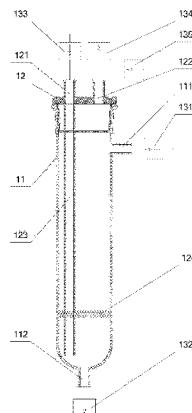
1. 一种洗气瓶,包括瓶体(11)和瓶盖(12),所述瓶盖(12)上具有进气口(121)和出气口(122),所述进气口(121)上设置有导气管(123),其特征在于,所述瓶体(11)上设置有吸收液添加口(111)和排液口(112),所述导气管(123)上套设有滤芯(124)。
