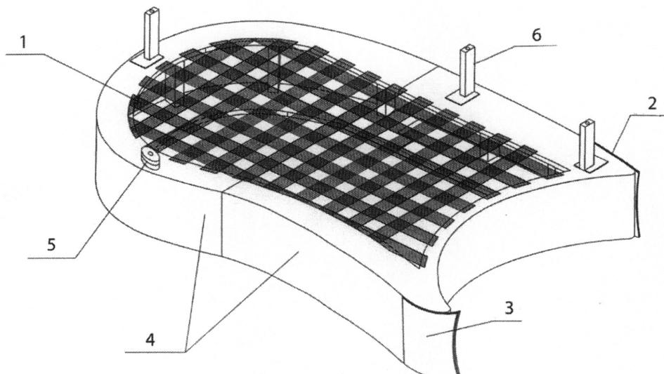
Фиг. 5 Схема сборки каркаса сидения секции.
