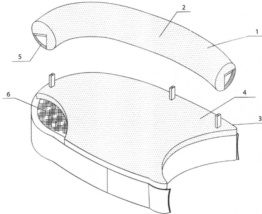
Фиг. 4 Вид сидения и спинки при оклейке их поролоном.
