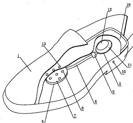
1. 一种复合减震功能鞋,包括鞋面、鞋底和中底,中底覆盖在鞋底的表面,鞋面固定在鞋底上,其特征在于鞋底的前部开有前泵槽,鞋底的后部开有后泵槽,后泵槽与鞋底侧面的出气孔连通,前泵槽通过主气道与后泵槽连通;前泵槽内安装有前气泵,后泵槽内安装有后气泵。
