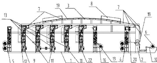
1. 一种多功能印刷定位机,其特征在于:包括印刷机(1)、放料装置(6)、复合热压转移装置(2)、烘干系统(3)、冷却装置(20)和收卷装置(4),其中所述的印刷机(1)的一侧依次安装有收卷装置(4)、复合热压转移装置(2)和放料装置(6);所述的烘干系统(3)架设在印刷机(1)、收卷装置(4)和复合热压转移装置(2)的上顶部,且分别与印刷机(1)、收卷装置(4)和复合热压转移装置(2)固连;所述的收卷装置(4)顶部与冷却装置(20)固连。
