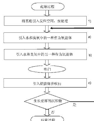
1. 在硅基底表面上生成沉积物的方法,所述沉积物包含氧化铝,其特征在于,所述方法包括下述任何顺序的交替步骤:
