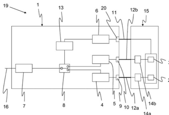
1. 一种用于操作压电声换能器 (2) 和/或动态声换能器 (3) 的具有至少一个音频放大器 (4、5) 的放大器单元 (1),
