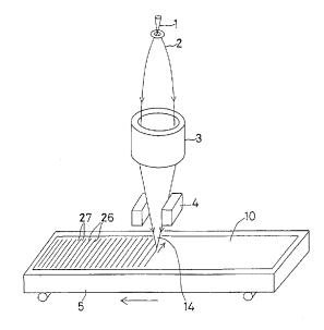
(57) Cette invention concerne un procédé de production d'un masque de phase destiné à la fabrication d'une fibre optique, qui minimise les erreurs d'épissures susceptibles de détériorer la capacité de sélection de longueur d'onde du réseau de diffraction de la fibre
