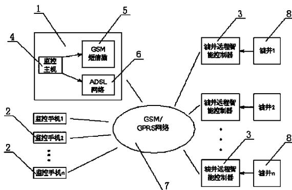
1. 油井远程监控装置,是由监控中心(1)、监控手机(2)和油井远程智能控制器(3)构成,其特征在于监控中心(1)是由监控主机(4)、GSM短信猫(5)和ADSL网络(6)组成,监控中心(1)、监控手机(2)和油井远程智能控制器(3)均与GSM/GPRS网络(7)通讯连接。
