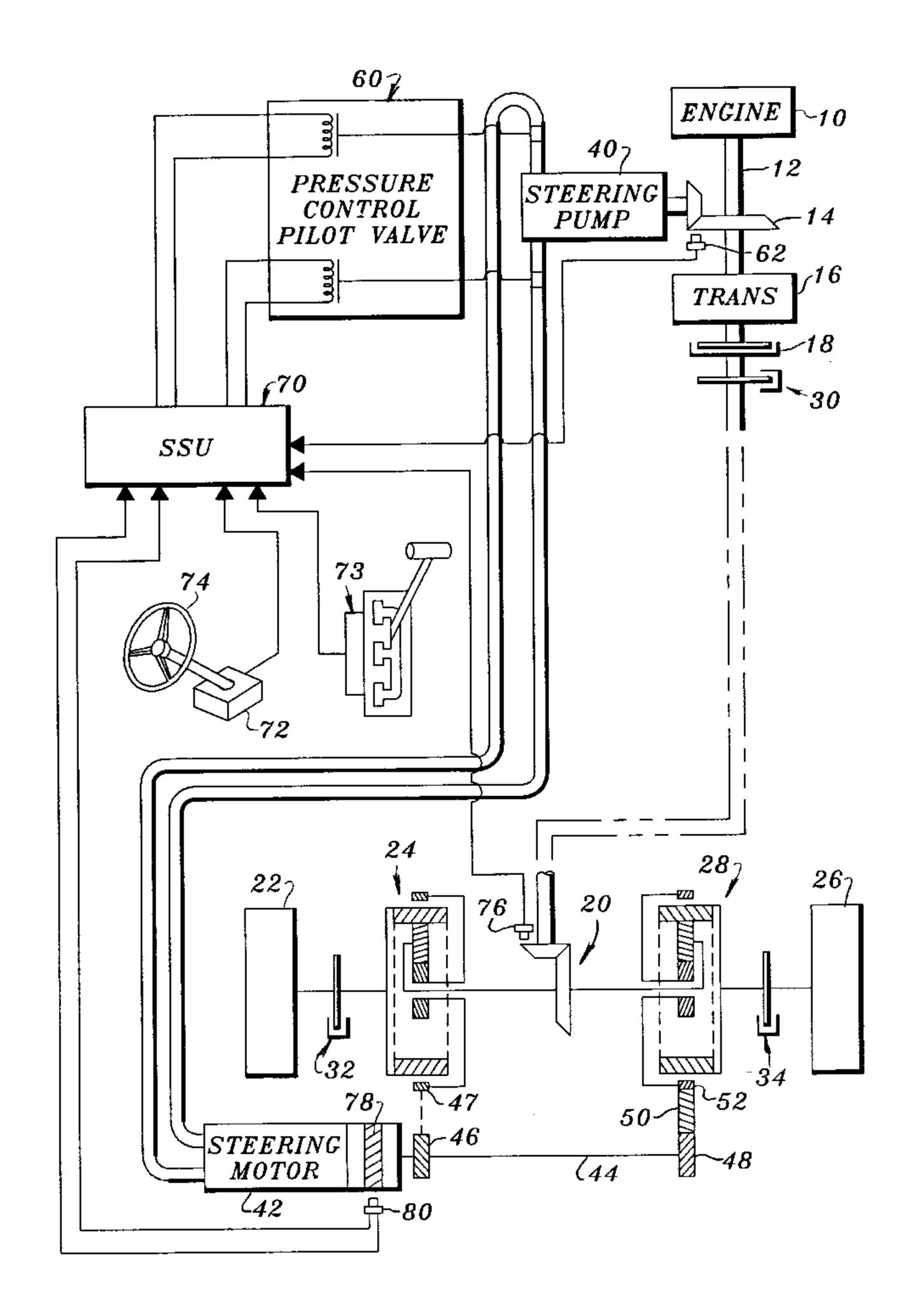
(57) Système de commande de direction pour véhicule à chenilles, comprenant une pompe de direction à cylindrée variable, actionnée par le moteur, qui alimente un moteur hydraulique. Ce dernier actionne un mécanisme d'entraînement à différentiel qui imprime un
