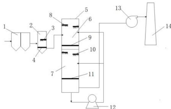
1. 一种燃煤电厂烟气脱硫脱硝一体化处理系统，其特征在于，包括依次连接的除尘系统、预处理系统、催化氧化系统、吸收系统、引风机和烟囱；所述预处理系统用于去除烟气中HCl、HF；所述催化氧化系统用于将烟气中的SO<sub>2</sub>和NO分别催化氧化为SO<sub>3</sub>和NO<sub>2</sub>；所述吸收系统用于吸收SO<sub>3</sub>和NO<sub>2</sub>；
