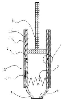
1. 焊锡装置,其特征在于:包括耐热管体(1),所述耐热管体(1)内设置有电热丝(2),所述耐热管体(1)外部包裹有隔热层(3),所述耐热管体(1)一端开口另一端设置有柱塞(4),所述耐热管体(1)分为管体上部(11)和管体下部(12),所述管体上部(11)和所述管体下部(12)采用螺纹(6)连接。
