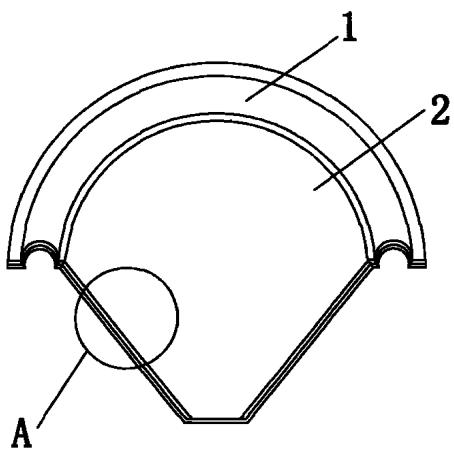
1、一种改进的扬声器振盆，包括振动体（2）和与振动体相连的主体截面呈拱形的振盆边（1），其特征在于：所述的振动体由纸质基材（21）和设置在纸质基材上的膜状材质层（22）构成。
