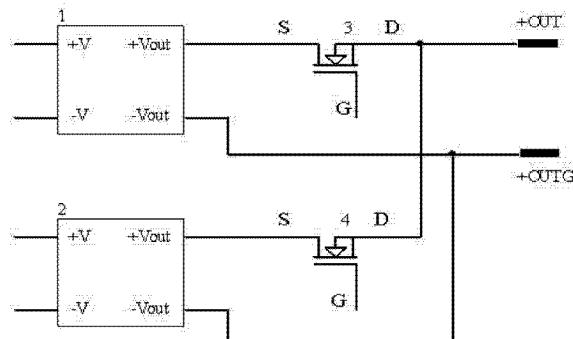
1. 一种 MOS 管当作冗余二极管的 DC-DC 电路, 其特征是 : 包括第一 DC-DC 模块、第二 DC-DC 模块、第一 MOS 管、第二 MOS 管和直流输出端口 ;
