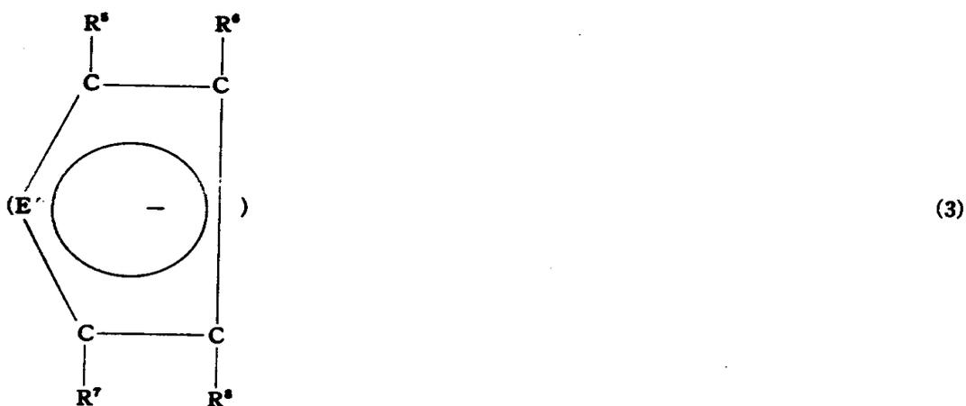
상기식에서 E와 E'는 각기 주기율표의 5족 또는 5B족의 헤테로 원자이고, R<sup>1</sup>, R<sup>2</sup>, R<sup>3</sup>, R<sup>4</sup>, R<sup>5</sup>, R<sup>6</sup>, R<sup>7</sup>, 및 R<sup>8</sup>은 각기 서로 같거나 또는 상이할 수 있는 것으로서, 수소, 또는 알킬기, 아릴기 또는 아르알킬기와 같은 탄화수소기, 또는 아실기, 시아나이드기, 실릴기 또는 게르밀기이고, M<sup>1</sup>은 주기율표 3A족 내지 8족의 전이금속이고, X는 서로 같거나 또는 상이할 수 있는 것으로서, 수소, 알킬기, 아릴기, 아르알킬기, 아실기, 시아나이드기, 실릴기, 게르밀기, 아미드기, 아지드기, 포스파이드기, 알콕시드기, 아릴옥시드기, 실릴옥시드기, 술폰이드기, 또는 할로겐이고, 그리고 n은 1 내지 4의 정수이다).
