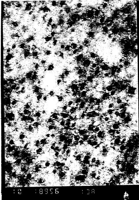
실시에 1의 EVOH 수지 조성물 펠릿 중의 분산 형태를 투과형 전자 현미경으로 관찰한 사진 (배율 20000배)
