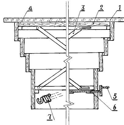
1. 一种用 3D 画装饰可变餐桌茶几,其特征在于:包括钢化玻璃台面(1)、3D 画及托板(2)、可伸缩底座(4)、叉式连杆升降结构(3),叉式连杆升降结构(3),上面固定 3D 画托板(2) 和钢化玻璃台面(1),四周固定可伸缩底座(4),人手转动螺杆控制器(6) 上的手轮(5),在人力和弹簧力作用下,让叉式连杆升降结构(3) 作低副运动带动钢化玻璃台板(1) 快捷升高或降低,可伸缩底座(4) 也随之伸缩,停止转动,成餐桌状或茶几状。
