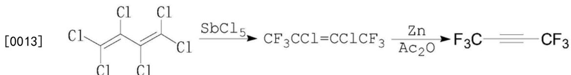
[0014] 六氯丁二烯为甲烷氯化物生产过程中产生的副产物,该路线以六氯丁二烯为原料具有成本优势,但以锌粉作为脱氯剂,反应放热量大,温度难控制,选择性不好(有氢头副产),金属盐三废量大,难处置,不宜产业化。
