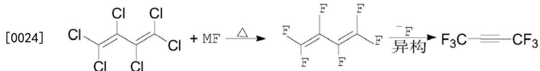
[0025] 反应温度对反应效果有较大影响,反应温度太高会有聚合副产物的生成,使得产物选择性降低;反应温度太低,反应速率低,原料转化不完全,大部分停留在中间体状态,使得产物收率降低。因此,本发明中的反应温度优选为50~300℃,更优选为100~250℃。
