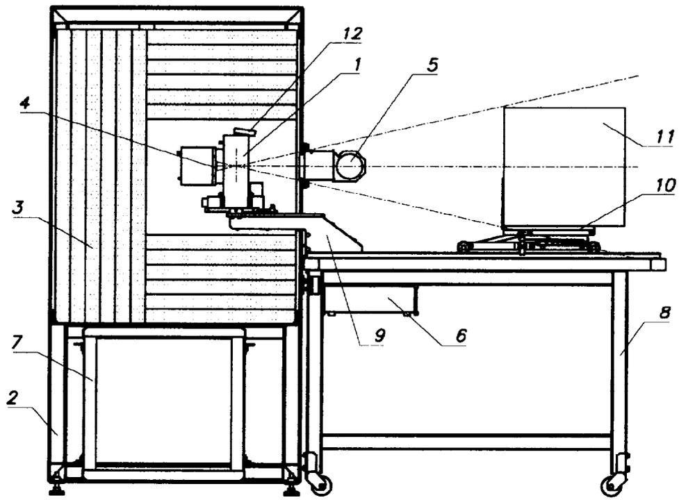
Полезная модель относится к области устройств, предназначенных для дистанционного неразрушающего обнаружения и определения пространственного положения скрытых взрывчатых и наркотических веществ (ВВ и НВ), находящихся в сейфах, контейнерах небольшого размера, а также в ручной клади.
