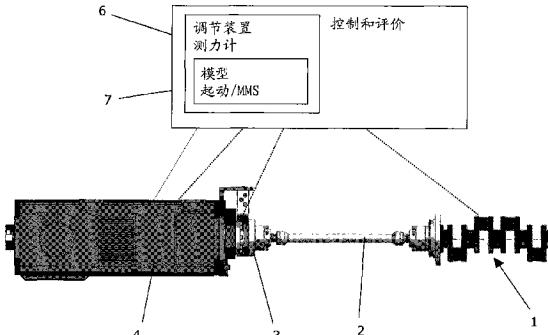
1. 一种具有试样 (1) 的试验台装置, 所述试样与一个或多个用来驱动和 / 或加载所述试样 (1) 的电机 (4) 以及调节装置 (6) 相连, 所述调节装置 (6) 用于一个或每个用来驱动和 / 或加载所述试样 (1) 的所述电机 (4), 其特征在于, 在调节装置 (6) 中执行至少一个用于可连接到试样 (1) 上的构件的模型 (7), 由所述模型 (7) 确定对一个或每个电机 (4) 的调节要求的至少一部分, 在调节装置 (6) 中执行至少一个用于多质量飞轮的模型 (7), 所述模型 (7) 至少包含多质量飞轮的初级侧和次级侧的两个质量, 并包含用于一个或每个弧形弹簧的替代模型, 其中在调节装置 (6) 中执行通过时间步长积分法来评价用于多质量飞轮的模型的算法。
