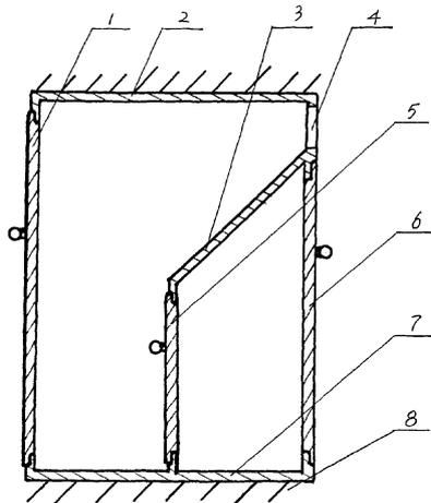
1. 多功能传递箱, 该箱包括室内、外门(1、6)、箱体(2、7)、箱中门(5)及滑板(3)四部分; 其特征是: 该箱有一个方形的箱体(2、7), 箱体(2、7)前后各安装有向外箱开的室外门(6)及室内门(1); 在箱体(2、7)的正前上方, 有一道横向的开口为投递口(4), 顺着投递口(4)向箱内下方, 斜向的安装一面可使信件滑下的滑板(3), 滑板(3)与下方的箱体(7)之间, 安装一面向后开的箱中门(5); 该箱体(2、7)整体的安装在墙体(8)中间, 室内门(1)在室内, 室外门(6)在室外。
