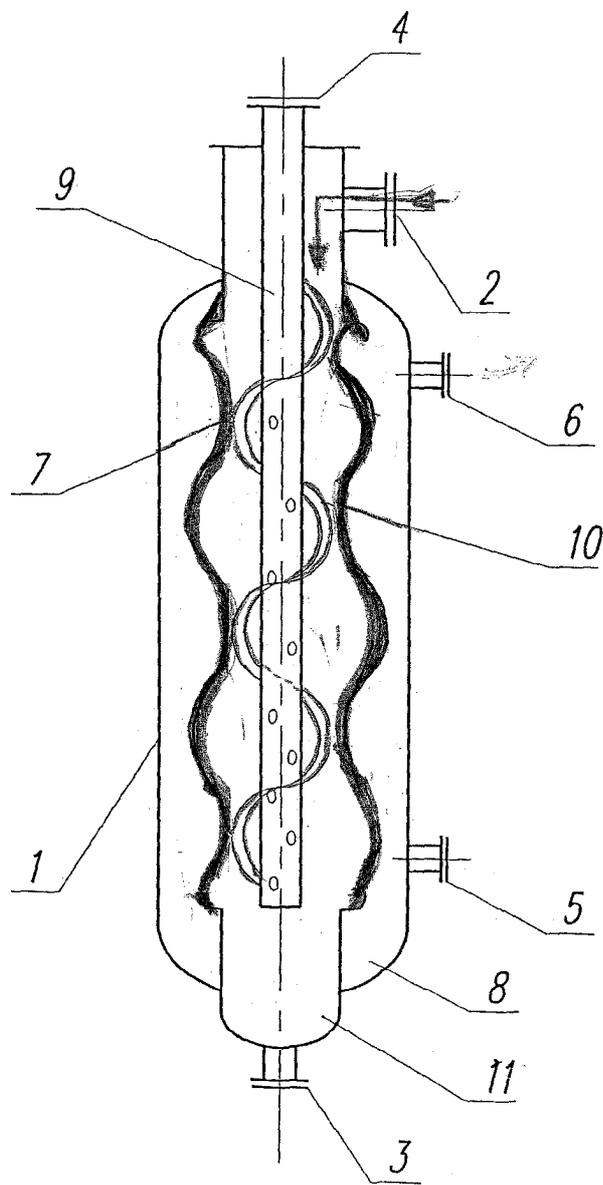
Полезная модель относится к тепломассообменной аппаратуре и может быть использована в химической, теплоэнергетической и других отраслях промышленности для конденсации паров, а также для охлаждения парогазовых смесей и удаления жидкой фазы при конденсации пара.
